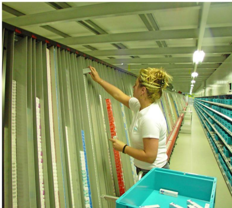
In den zwei Schichtautomaten werden mehr als 55 Prozent der Medikamente kommissioniert. Mitarbeiterinnen füllen die Kammern immer wieder mit Arzneimitteln nach, die aus dem Hochregallager kommen.
