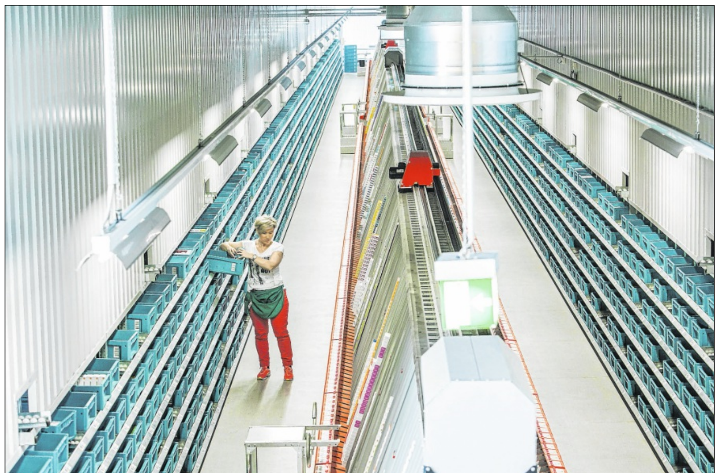
65 METER VOLL MIT MEDIKAMENTEN: Der Schachtautomat (Mitte) ist für den Pharmagroßhändler Fiebig besonders wichtig. 50 Prozent der Menge, die bei dem Unternehmen raus geht, meistert diese Technik. Nachschub kommt aus den Hochregallagern.
