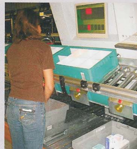
Die lichtgesteuerte Anlage hilft dabei, Fehler zu vermeiden
